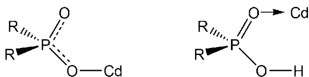
Figura 28 – Modos de coordenação do ligante bisfosfinato e ácido bisfosfínico no composto 3 .
