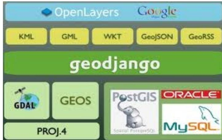
Figura 17 - Arquitetura de uma aplicação com o GeoDjango
