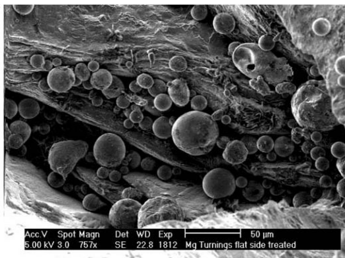
Figura 11. Gotículas esféricas resultantes da fusão de magnésio. Representação adaptada da ref. [45].
