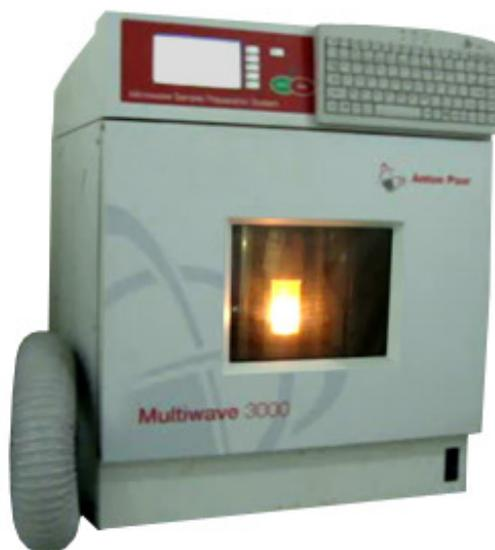
**Figura 4.** Forno de micro-ondas no momento da combustão iniciada por micro-ondas, sem a capa do rotor e proteção do frasco com corte para observação da combustão.
