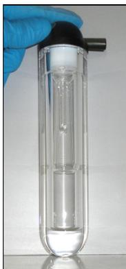
**Figura 11** Frasco de quartzo com amostra de salsa após MIC utilizando como solução absorvedora  $(\text{NH}_4)_2\text{CO}_3$   $50 \text{ mmol l}^{-1}$ .
