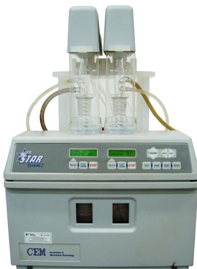
**Figura 6.** Sistema de micro-ondas focalizadas de duas cavidades com condensadores de circulação de água.
