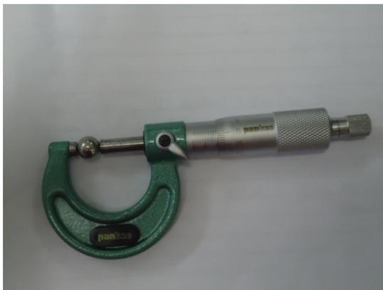
Figura 12 - Micrômetro analógico utilizado para a aferição das esferas de moagem.
