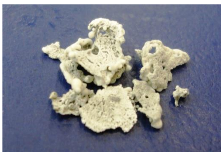
Figura 28. Resíduo da amostra cloridrato de prometazina após decomposição por MIC.
