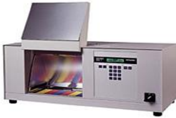
Figura 6- Simulador de envelhecimento UV geralmente adaptado para o uso em asfaltos.
