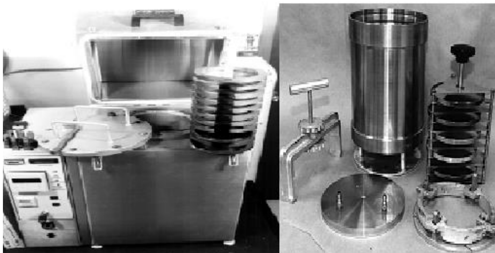
Figura 5- Equipamento utilizado para o ensaio de envelhecimento a longo prazo (PAV).
