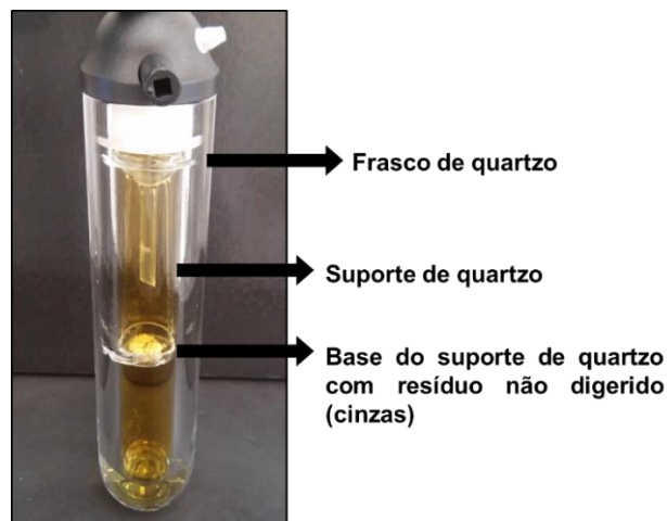
Figura 6. Imagem do frasco de quartzo com a fração remanescente na base do suporte, após a combustão de 250 mg do carvão C1.
