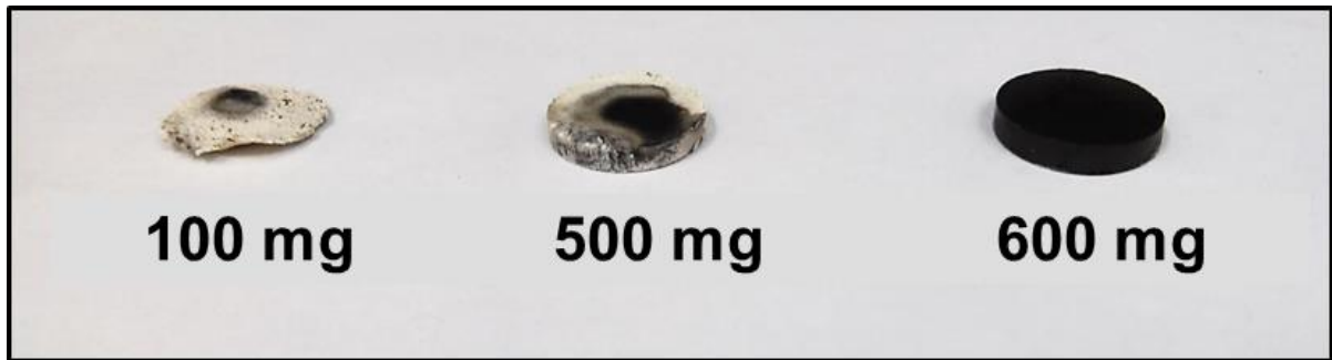
Figura 11. Imagem do resíduo remanescente após a combustão de 100, 500 e 600 mg do carvão B2.
