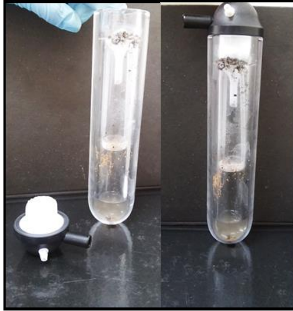
Figura 9. Aspecto do frasco e da tampa para combustão de 400 mg do carvão A2.
