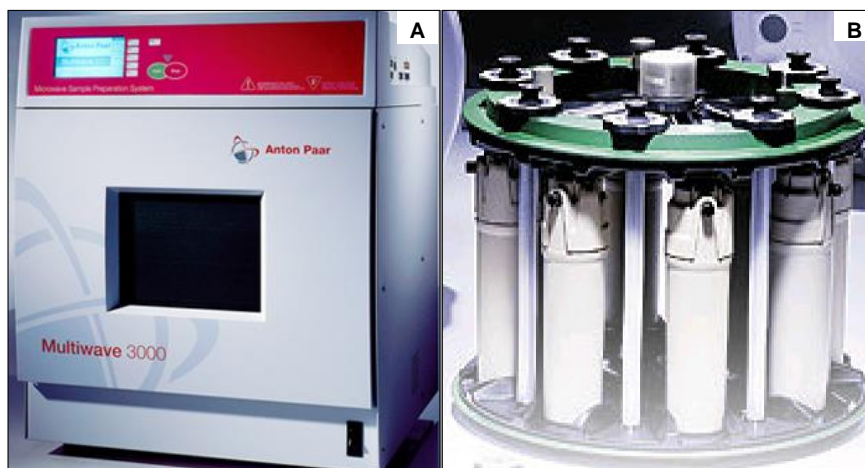
Figura 3. A) Forno de micro-ondas comercial Multiwave 3000 ® . B) Rotor equipado com 8 frascos de quartzo utilizado para a decomposição e extração das amostras. 114
