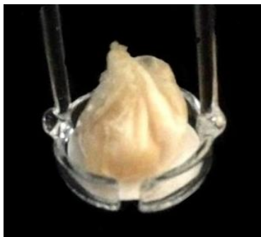
Figura 3. 500 mg de mel misturados a 200 mg de celulose microcristalina e 50 \mu\text{L} de \text{NH}_4\text{NO}_3 , envolvidas em um filme de polietileno.
