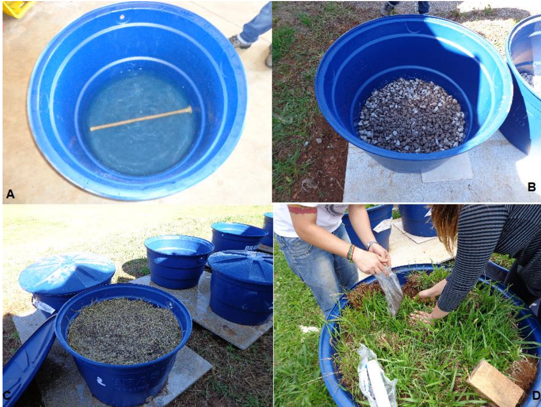
Figura 5 - Montagem dos reatores Foto: Luciano Gebler
