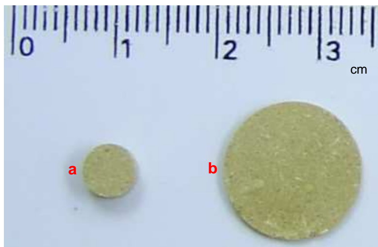
Figura 11. Comprimidos de erva-mate de a) 50 mg e b) 100 mg, com diâmetro de 5 e 13 mm respectivamente.
