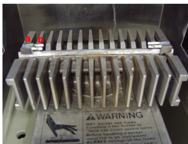
Figura 17. Queimador utilizado com o suporte para o tubo metálico. a) Suporte de aço-inox e, b) barras de cerâmica.
