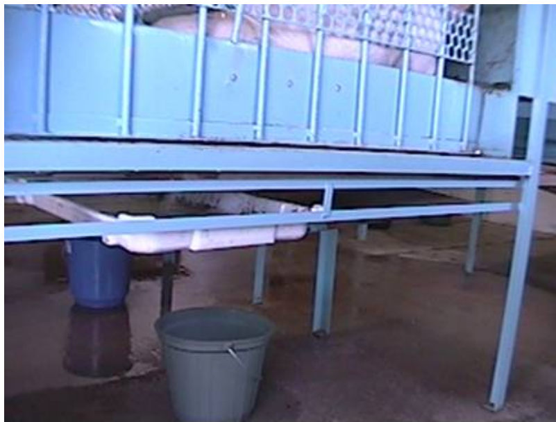
Figura 04 - Detalhe do sistema de coleta de excretas (fezes e urina) da gaiola metabólica
