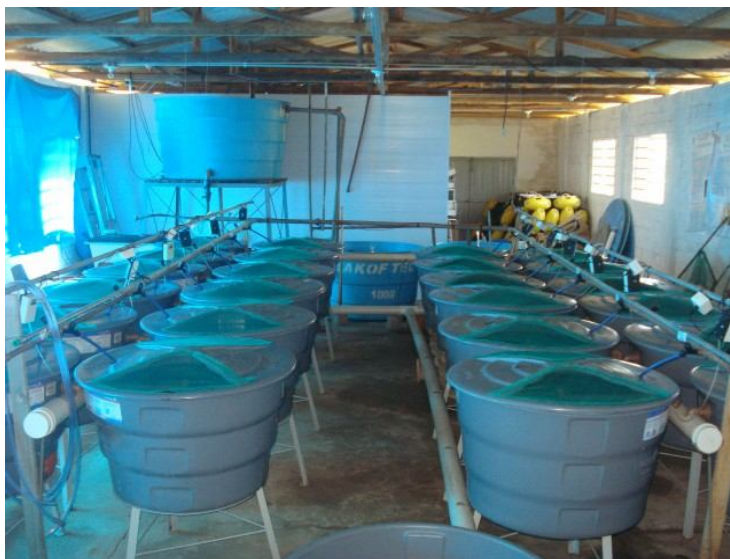
ANEXO 5 – Sistema de recirculação de água utilizado durante o período experimental
