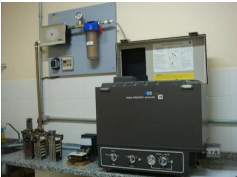
**Processadora de microfilmes e ao fundo o sistema hidráulico para aquecimento e filtragem da água**
