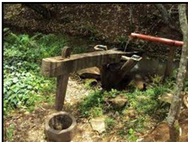
Figura 94 – Monjolo, dispositivo utilizado pelos imigrantes para descascar arroz.
