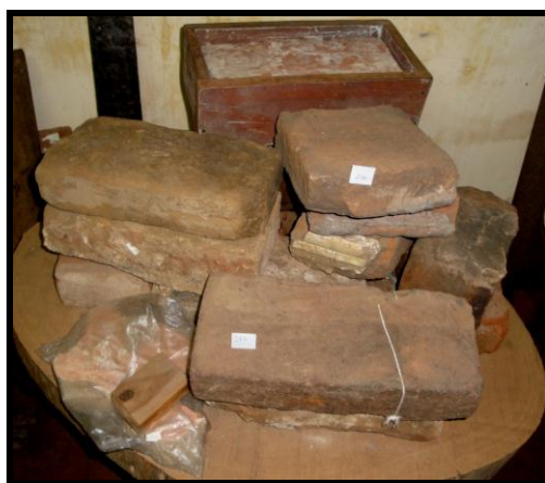
Figura 136 – Forma e tijolos elaborados a partir do barro amassado com os pés.
