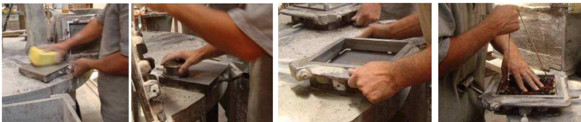
Figuras 57, 58, 59 e 60 - Colocação da forma ou matriz no bastidor. Fonte: CAMPOS, 2011, p. 61.
