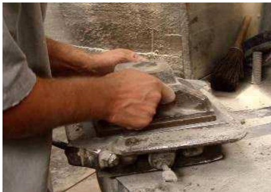
Figuras 67 e 68 - Fechamento do bastidor e a prensagem. Fonte: CAMPOS, 2011, p. 65; LADRIMINAS, 2012, respectivamente.
