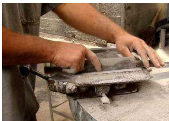
Figuras 63 e 64 - Colocação e regularização da massa intermediária ou secante. Fonte: LADRIMINAS, 2012.
