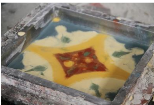
Figura 62 - Retirada do molde do bastidor. Fonte: LADRIMINAS, 2012.
