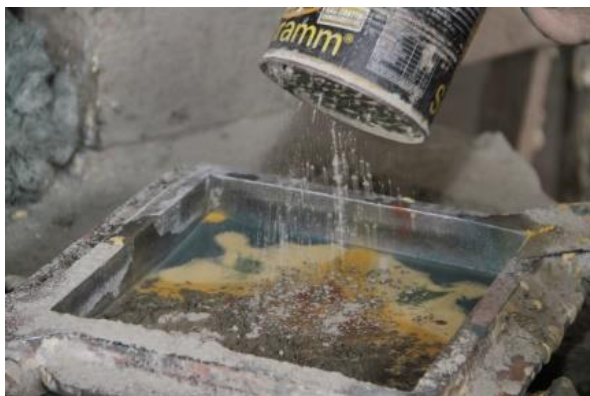
Figuras 63 e 64 - Colocação e regularização da massa intermediária ou secante. Fonte: LADRIMINAS, 2012.
