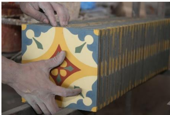
Figuras 69 e 70 - Retirada da peça da base para repouso de cura da argamassa. Fonte: LADRIMINAS, 2012.
