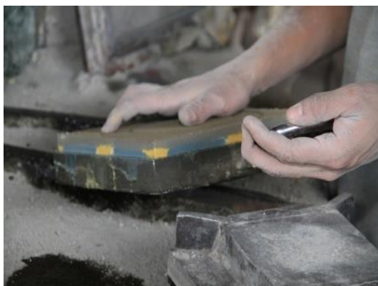
Figuras 69 e 70 - Retirada da peça da base para repouso de cura da argamassa. Fonte: LADRIMINAS, 2012.
