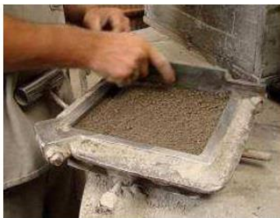
Figuras 65 e 66 - Colocação e regularização da argamassa base. Fonte: CAMPOS, 2011, p. 65.
