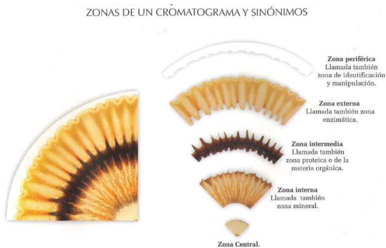
Figura 2.2 – Representação das partes (zonas) que compõe um cromatograma.
