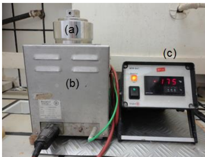
Figura 9. Sistema Berghof empregado na hidrólise ácida das biomassas. Componentes: (a) morteiro de aço inox; (b) sistema de aquecimento/resfriamento; (c) controlador de temperatura.
