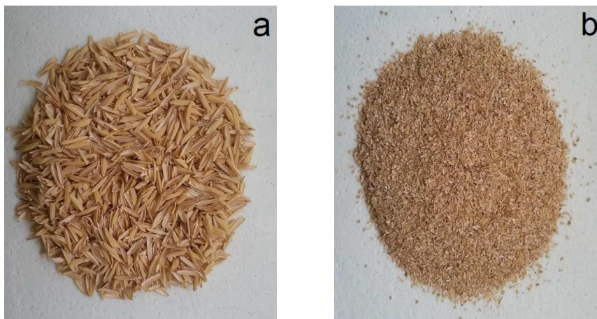
Figura 6. Amostra de casca de arroz utilizada nos processos: a) in natura ; b) cominuída à 288-312 \mu m.
