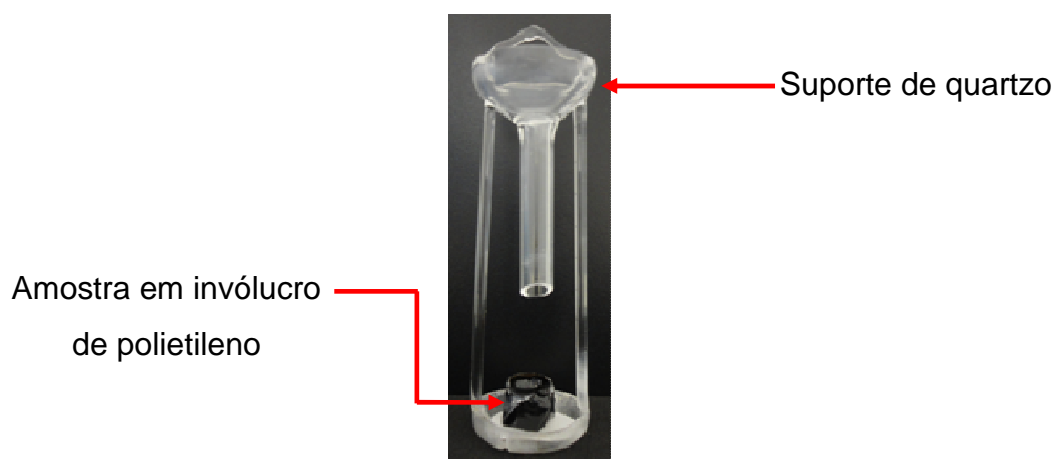
Figura 3. Amostra de petróleo inserida no invólucro de polietileno, posicionada na base do suporte de quartzo.
