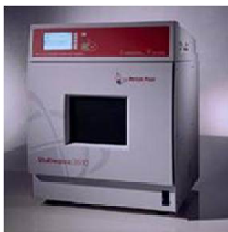
Figura 2. Forno de micro-ondas comercial utilizado para a decomposição das amostras por MIC e para a extração com água.
