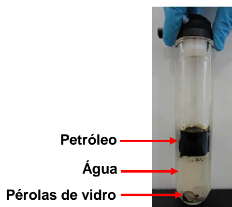
Figura 4. Frasco de quartzo utilizado na extração com petróleo, água e pérolas de vidro.
