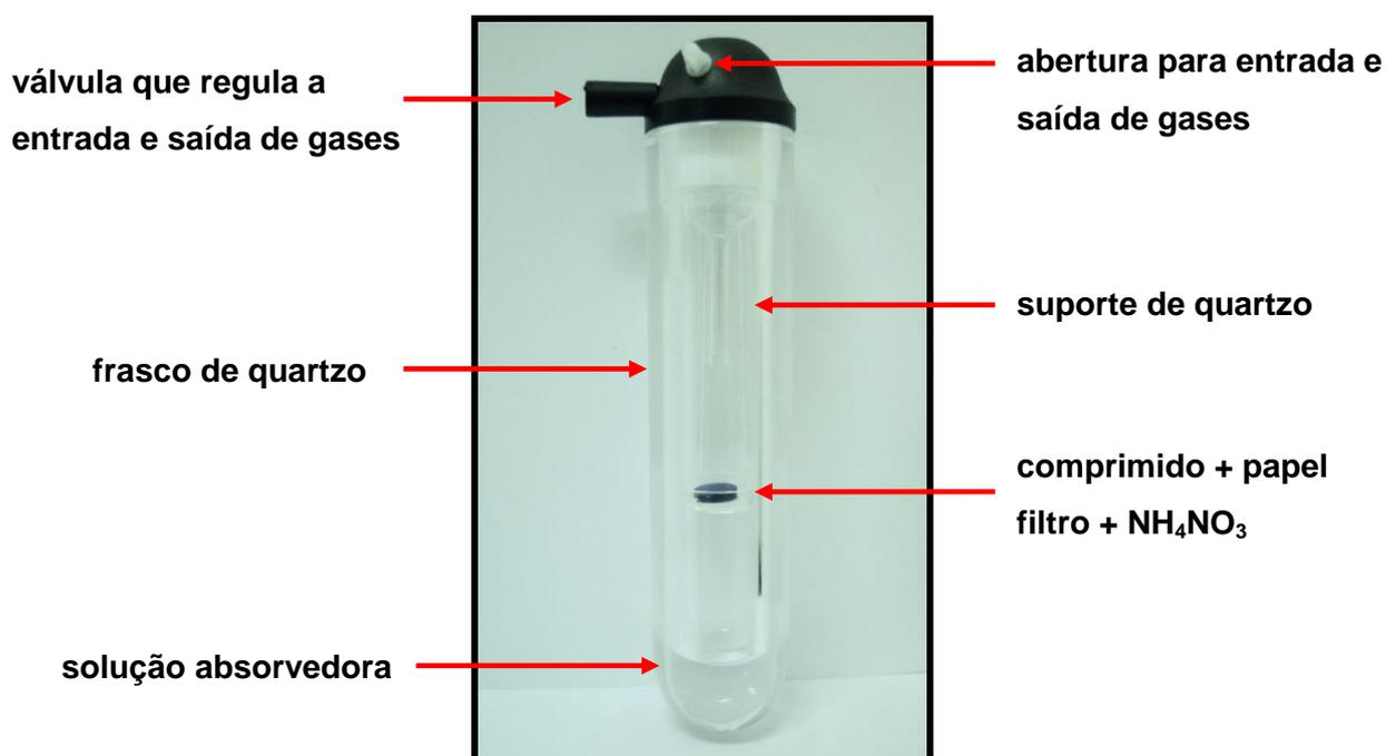
**Figura 7.** Amostra de carvão na base do suporte de quartzo, no interior do frasco, para a decomposição por MIC.
