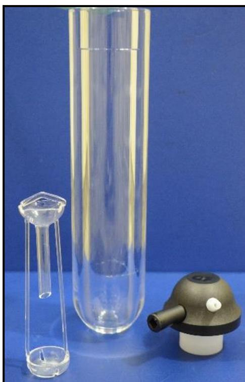
**Figura 3.** Frasco de quartzo, suporte e tampa de PTFE empregados na decomposição por combustão iniciada por micro-ondas.
