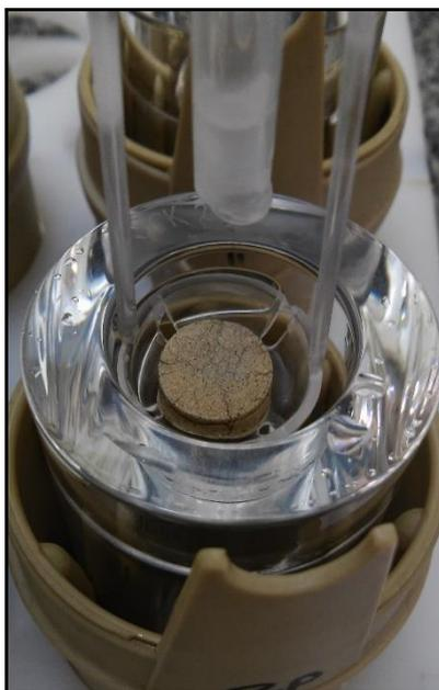
**Figura 12.** Aspecto do comprimido com 1000 mg de carvão C após a decomposição por MIC, mostrando a cinza remanescente após a combustão.
