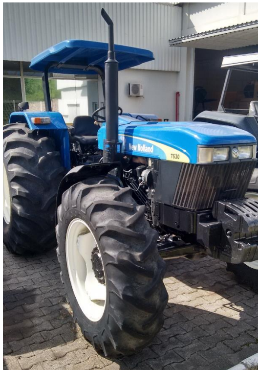
Figura 33 - Trator agrícola que apresentou a menor conformidade com a norma ISO 15077.
