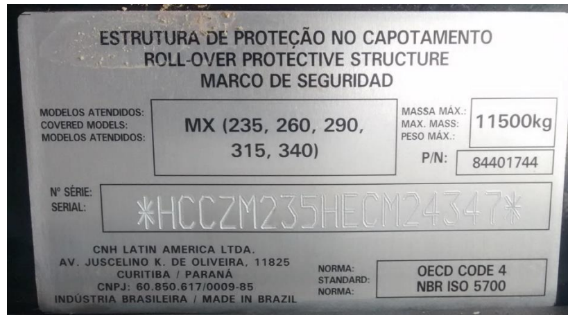
Figura 1 - Placa de identificação de uma estrutura de proteção do posto de operação de um trator agrícola.
