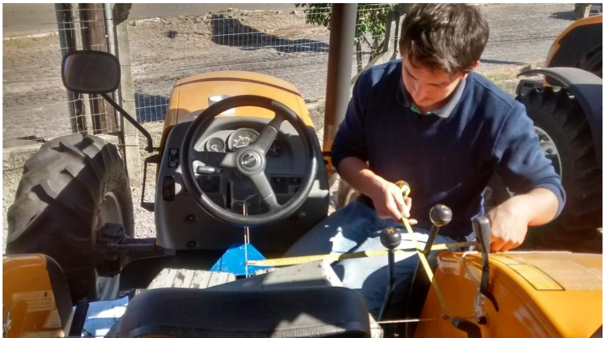
Figura 3 - Aquisição das medidas ergonômicas dos postos de operação.
