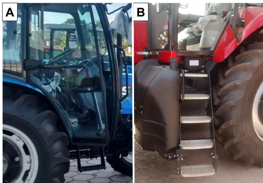
Figura 35 - Configuração dos degraus de acesso ao posto de operação: Monodegrau (A), Multidegraus (B).
