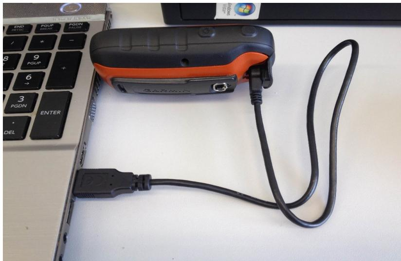
Figura 4: Conectando o receptor GNSS no computador (imagem colorida). Fonte: Autores.
