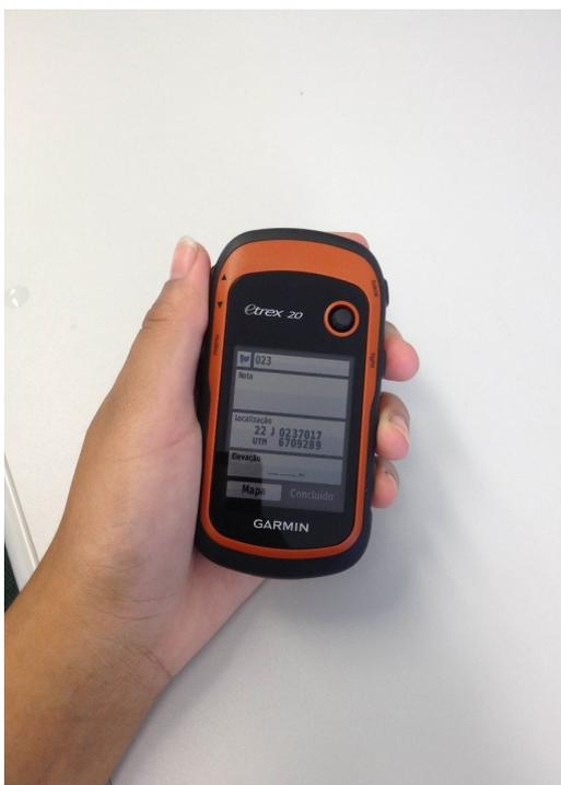
Figura 1: Receptor GNSS Garmin modelo Etrex® 20 – propriedade do Colégio Politécnico da UFSM (imagem colorida). Fonte: Autores
