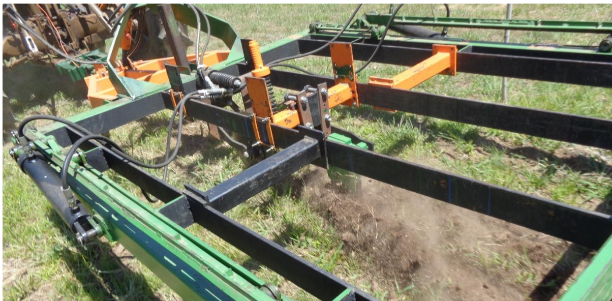
Figura 44 - Redução do valor de área elevada por projeção de solo
