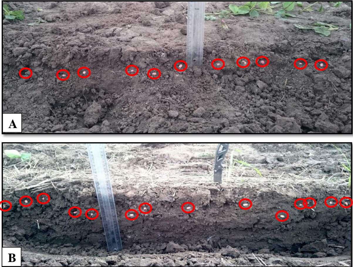
Figura 1- Distribuição de sementes de soja em função da utilização de mecanismos sulcadores da semeadora em área de terras baixas compactada: Disco duplo a 0,07 m de profundidade (A) e Haste sulcadora a 0,23 m (B). Santa Maria, RS. 2017.
