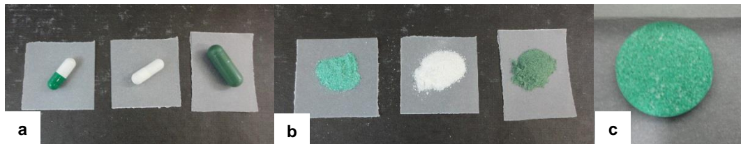
Figura 2. Cápsulas gelatinosa, gelatinosa gastrorresistente e cápsulas de HPMC (a) inteiras, (b) após moagem e (c) cápsula gelatinosa na forma de comprimido.
