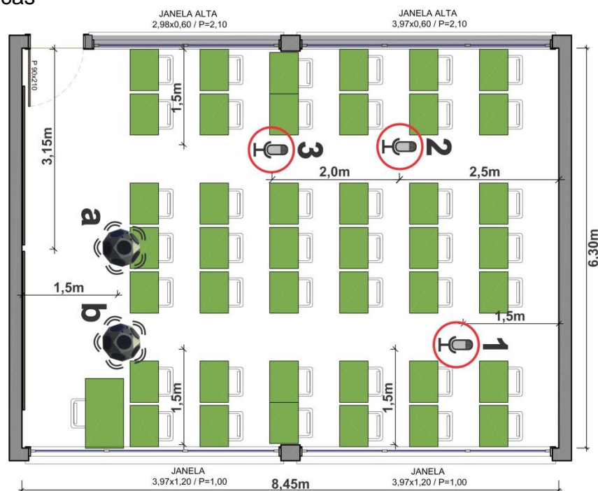
Figura 20. Planta baixa da escola A – Sala 1 e 2 possuem mesmas dimensões e características
