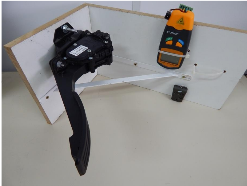
Figura K.10 – Acelerador veicular e tacômetro via dois cabos ethernet.
