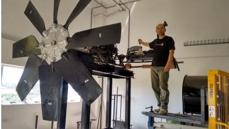
Figura K.8 – Hélice da Multi-Wing de 2700 mm de diâmetro.
