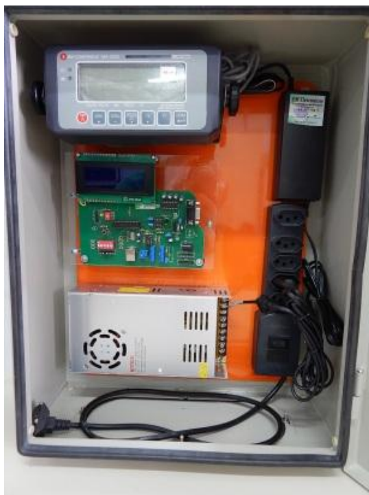
Figura K.12 – Quadro elétrico para leitura da potência mecânica de turbinas em testes.
