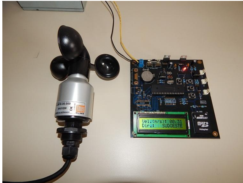
Figura K.14 – Anemômetro THIES Compact e o Data Logger desenvolvido.
