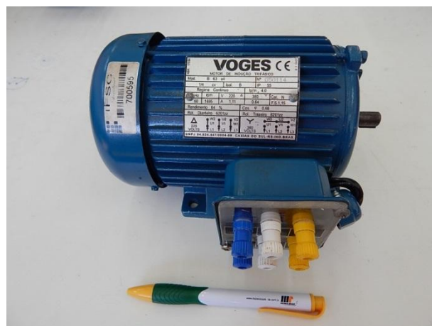
Figura E.1 – Motor de indução trifásico de ¼ CV.
