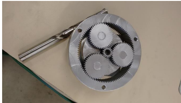
Figura 6.5 – Caixa de engrenagens planetária acoplado ao motor brushless CC BLM57180 da Leadshine.
