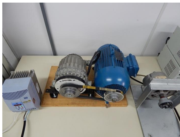
Figura I.2 – Bancada com motor de indução trifásico (centro) e inversor. PMSG da Wind Baron (esquerda) e Better Wind (direita)
