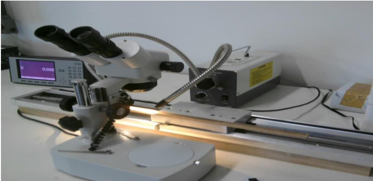
Figura 11 - Mensuração dos anéis de crescimento através do estéreo microscópio do Laboratório de Análise Digital de dados do Centro regional Sul de pesquisas Espaciais/INPE.
