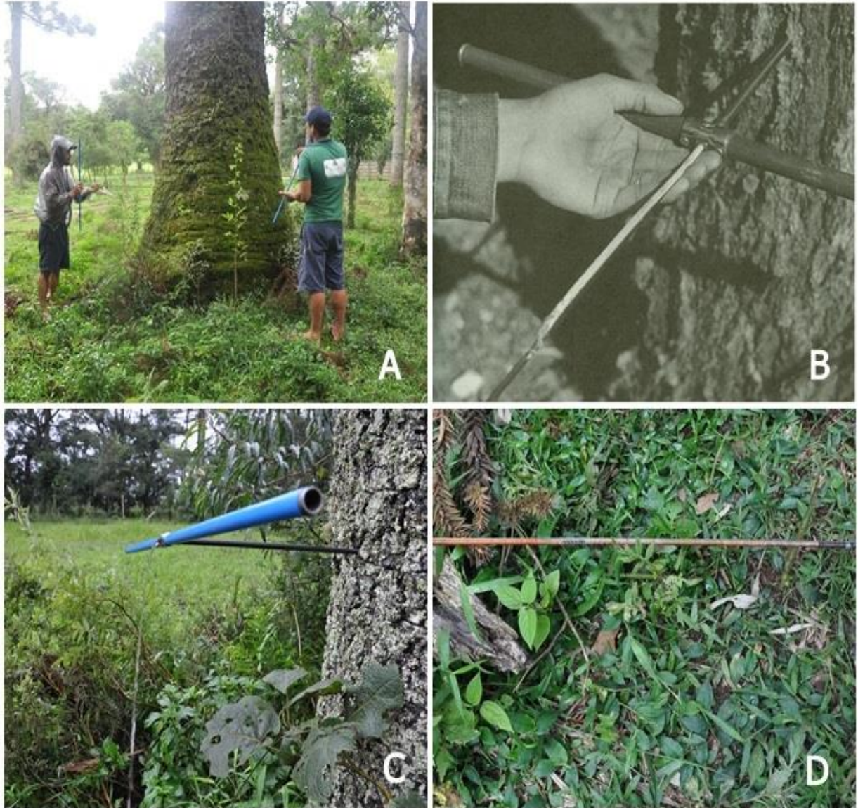
Figura 7 – Técnica de retirada da amostra não destrutiva com o Trado de Pressler no município de Tapera RS (A), Remoção da amostra (B), Imagem logo após a retirada da amostra (C) e Amostra retirada com o Trado de Pressler pronta para ser acondicionada (D).
