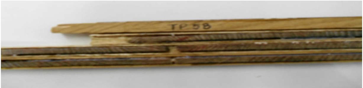
Figura 10 – Amostra das caneletas de madeira do município de Tapera, árvore 5 e raio B depois de lixada, pronta para ser digitalizada e analisada no estéreo microscópio.
