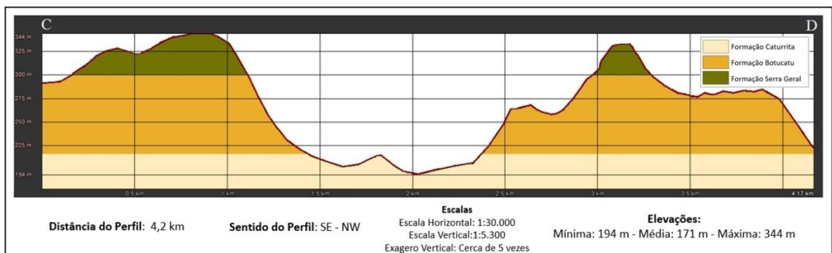
Figura 10 – Perfil geológico-topográfico do segmento C – D na área de estudo
