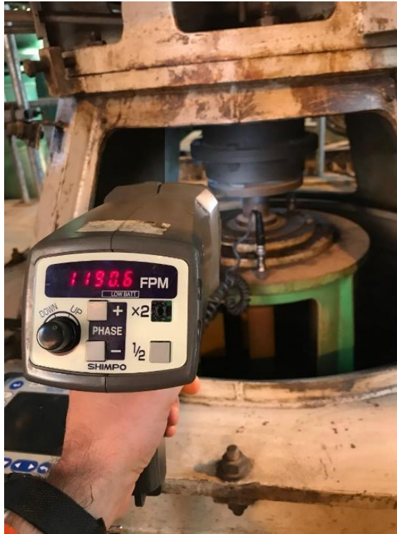
Figura 14 – Medição de rotação com Shimpo
