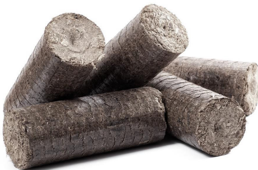
Figura 4 - Briquetes Produzidos com Resíduos Madeireiros.
