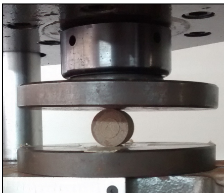
Figura 16 - Ensaio mecânico para a determinação da resistência a compressão dos briquetes.
