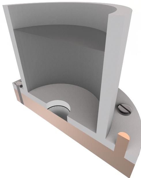
Figura C.2: Representação da célula eletroquímica, vista em corte.
