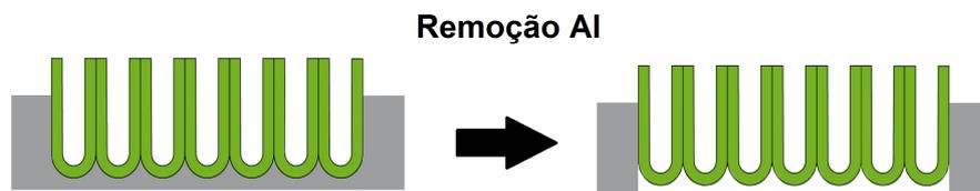
Figura 4.7: Representação do processo de remoção da camada de alumínio da membrana porosa.
