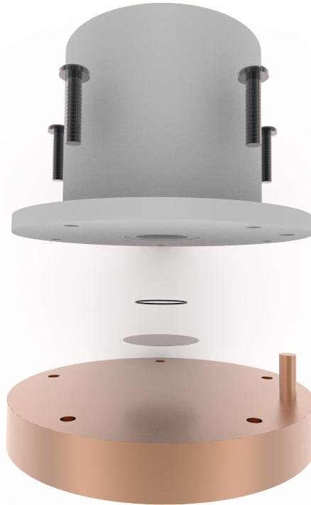
Figura C.1: Representação da célula eletroquímica, vista explodida.
