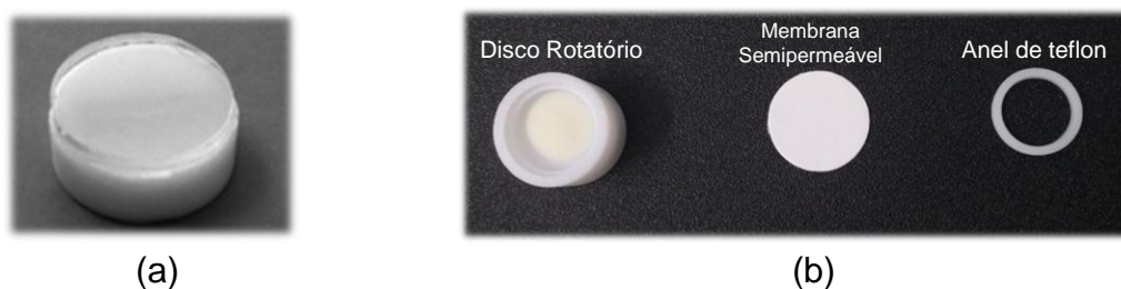
Figura 5 - Representação dos dispositivos utilizados na RDSE em (a) a versão clássica da técnica com PDMS e em (b) a versão onde uma cavidade no disco é preenchida por um determinado sorvente.
