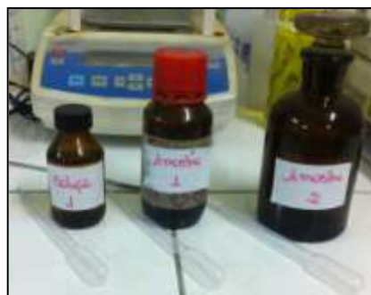
Figura 44 – Solução e amostras para identificação da função orgânica amina
