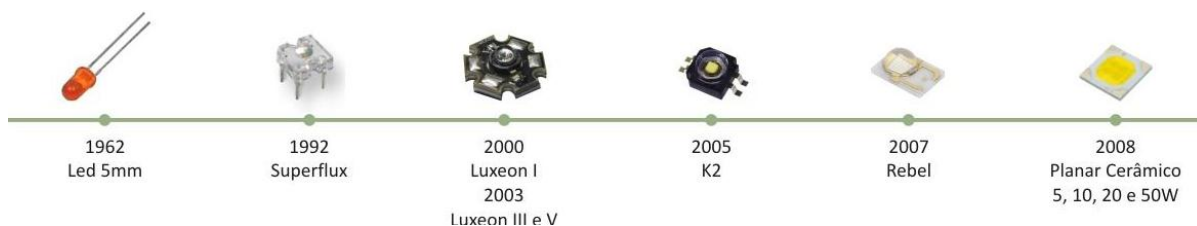
Figura 4 - Exemplares de LED e sua evolução ao longo dos anos. Fonte: Gois (2008).
