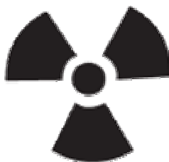
Figura 2: Símbolo de risco e manuseio para transporte e armazenamento de materiais – NBR 7500 – “Rejeito Radioativo”
