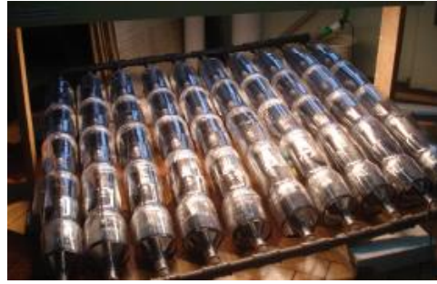
Figura 11 - Sistema de aquecimento com PET (montado em laboratório) Fonte: Coimbra; Azambuja; Dalmas; Coelho (2008 )
