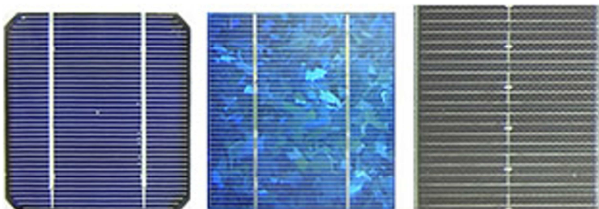
Figura 5 – Células Fotovoltaicas. Da esquerda para a direita, Silício: Monocristalino, Policristalino e Amorfo. (Fonte: http://processo-industrial.blogspot.com.br/2014_01_01_archive.html )
