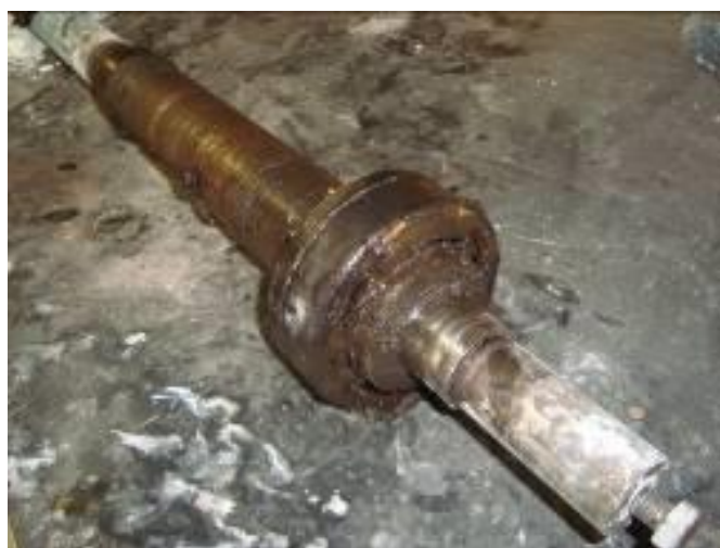
Figura 9 – Eixo com rolamento danificado.
