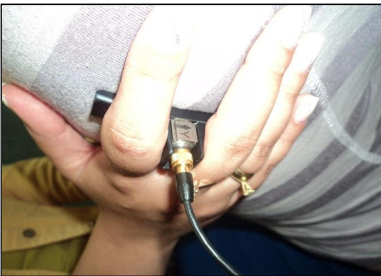
Figura 5 - Acelerômetro posicionado entre os dedos médio e indicador
