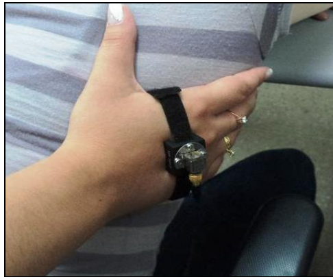
Figura 7 - Posicionamento do acelerômetro com o adaptador do tipo fita.
