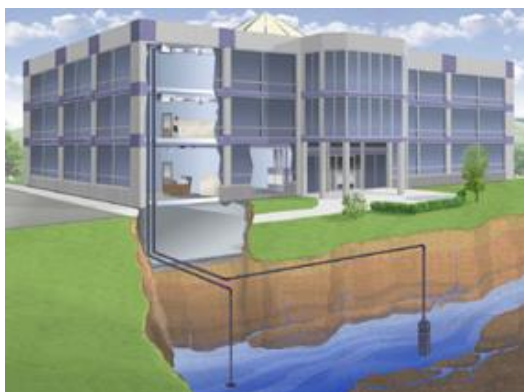
Fig. 2 - Sistemas aberto. Água subterrânea- Tomada e descarga para lençol freático.Fonte:www.georgia.daikinmcquay.com/McQuay/ProductInformation/WSHP/WSHPpageOld
