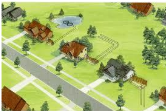
Fig. 1 –Sistemas com tubos fechados. Trocador em lagos, subsolo horizontal e subsolo vertical
