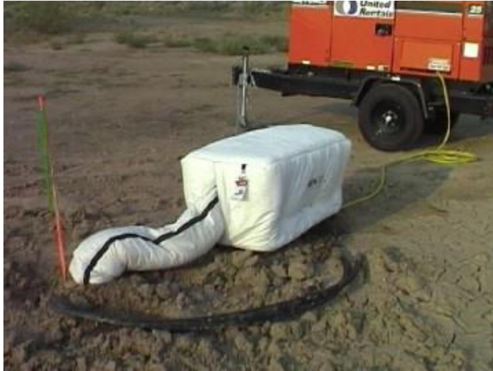
Figura 4 - Aparelho de teste de campo. Fonte: McQuay International-Geothermal Heat Pump- Design Manual
