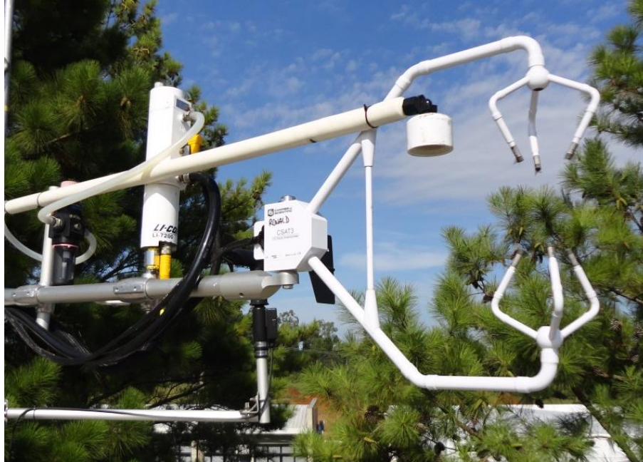
Figura 10: Analisador de CO 2 , vapor d'água e a pressão atmosférica. Fonte: A autora.
