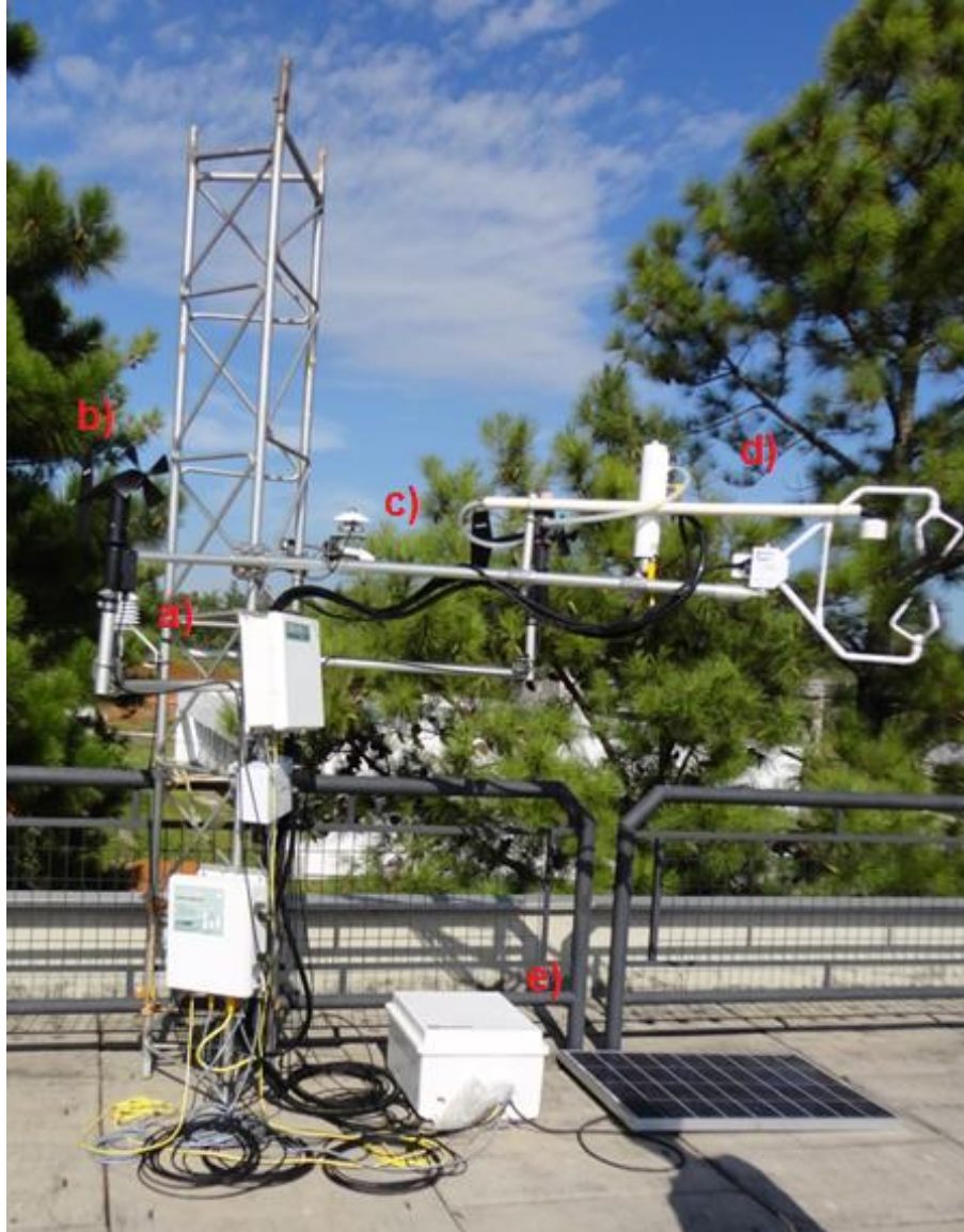
Figura 6: Torre micrometeorológica Eddy Covariance Fonte: A autora.
