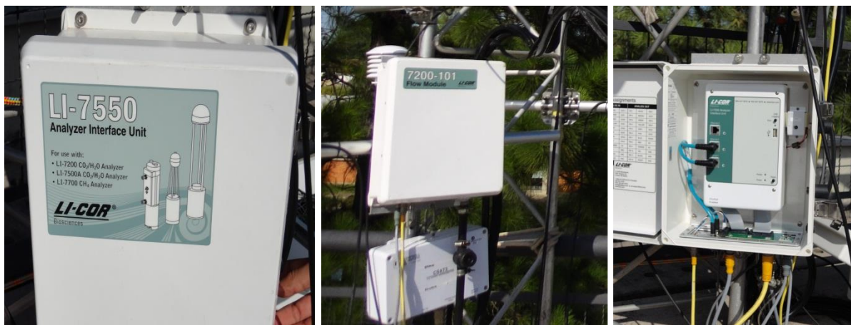
Figura 11: Unidade Auxiliar de Interface LI-7550 e Unidade Auxiliar de Interface LI-200. Fonte: A autora.
