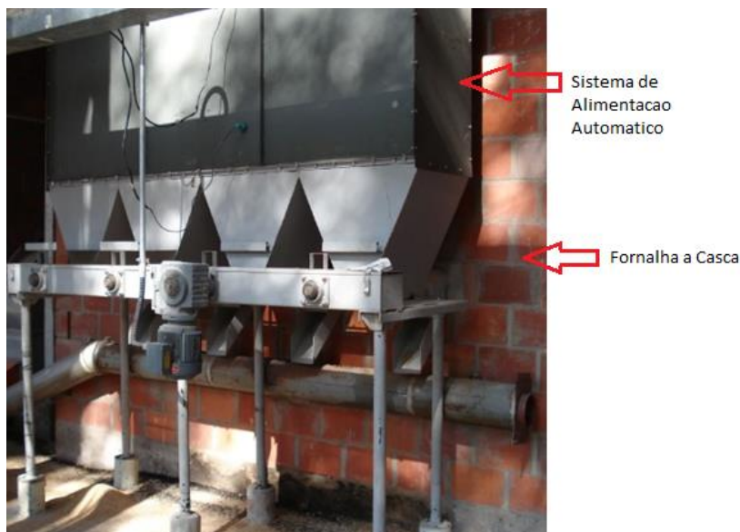
Figura 4 – Sistema de alimentação de asca na fornalha Fonte: A Autora (Kepler Weber- fabricante)
