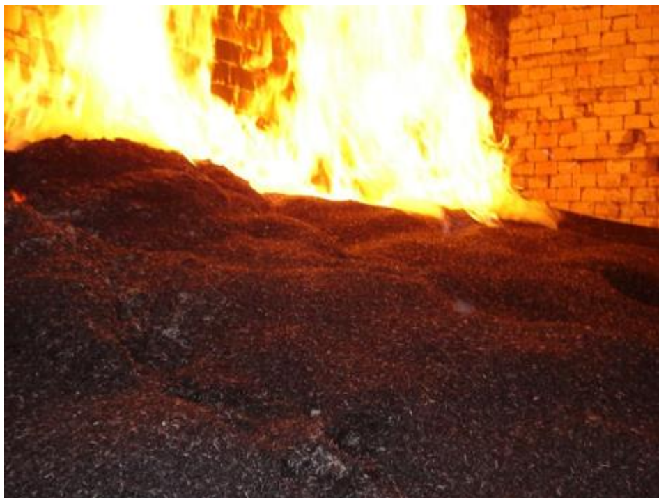
Figura 6 – Queima de Casca na Fornalha Fonte: A Autora (Kepler Weber- fabricante)
