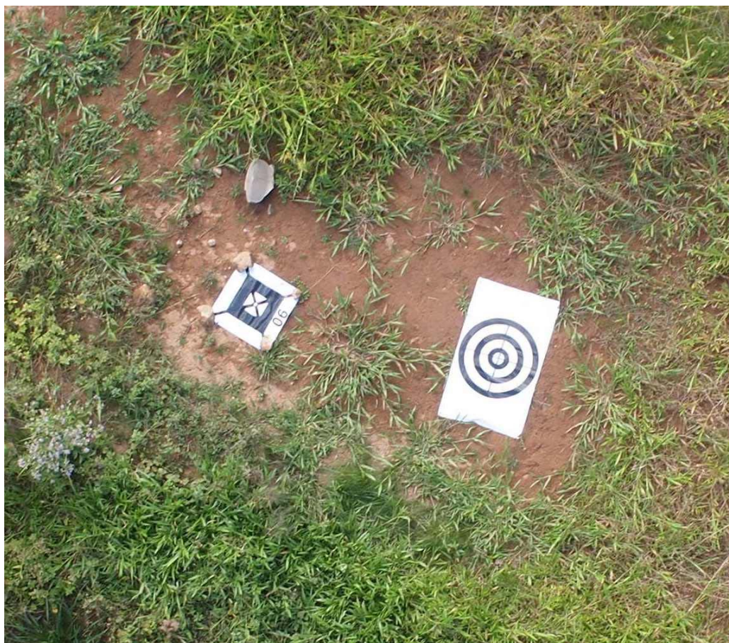
Figura 3 – Alvo de referência de decolagem, à direita, e alvo para pontos de controle, à esquerda.
