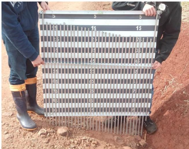
Figura 14: Determinação da rugosidade aleatória no microrelevo com uso do perfilômetro.
