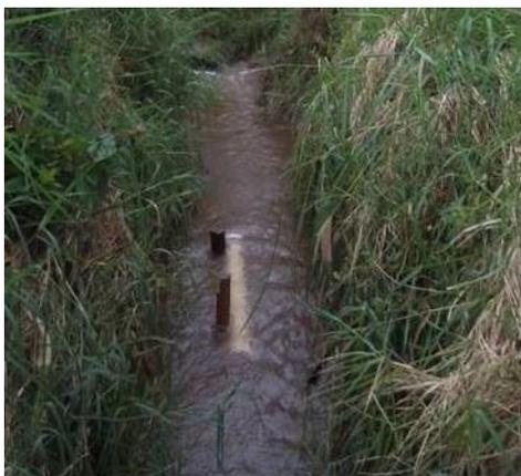
Figura 7: Amostradores integradores de sedimentos no tempo (torpedos).
