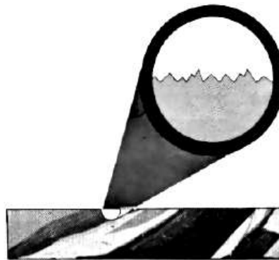
Figura 1 - Superfície com ampliação em destaque, evidenciando irregularidades das superfícies. Fonte: Araújo (2010, p.19).
