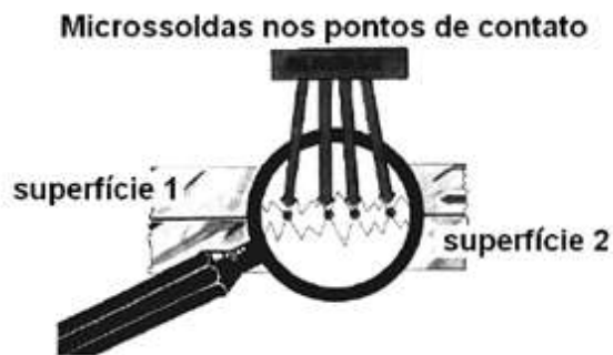
Figura 2 - Superfícies em contato e movimento surgimento de micros soldas devido o calor gerado pelo atrito. Fonte: Araújo (2010, p.20).
