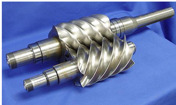
Figura 8 - Rotores compressor parafuso. Fonte: Produção do próprio autor.
