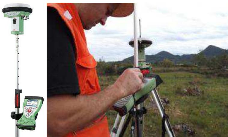
Figura 7 – Equipamento GNSS Leica Viva GS15
