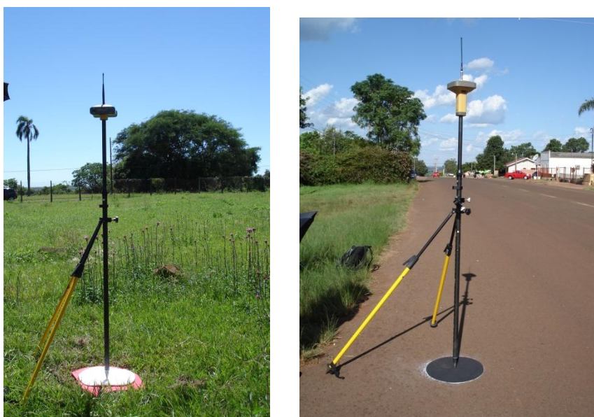
Figura 6 – Etapas de sinalização e medição dos pontos de apoio
