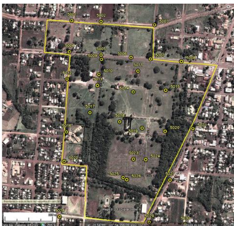
Figura 5 – Distribuição dos pontos de apoio do aerolevanteamento
