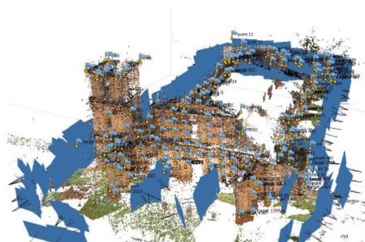
Figura 16 – Nuvem de ponto obtida pela fototriangulação
