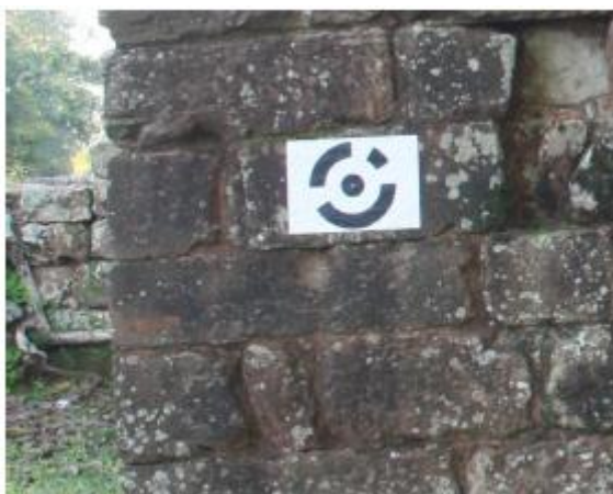
Figura 8 – Alvos pré-sinalizados nas fachadas
