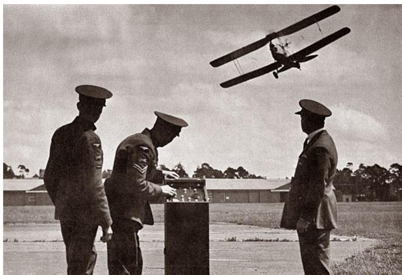
Figura 7. Un cabo de la Real Fuerza Aérea muestra los controles de un Havilland DH-82B Queen Bee , mientras un piloto oficial observa. Volar al Queen Bee a una altitud tan baja usando el panel de control requería una habilidad considerable. Fuente: Real Fuerza Aérea
