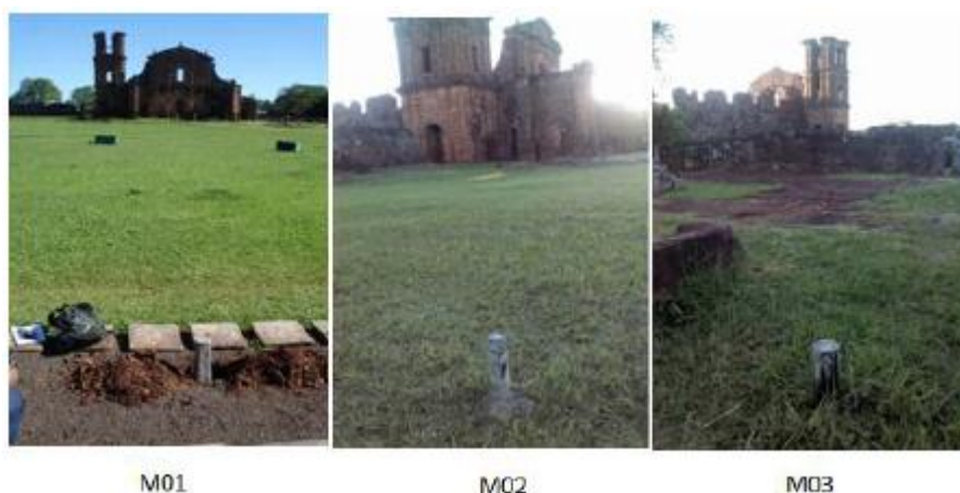
Figura 4 - Marcos geodésicos da rede geodésica local
