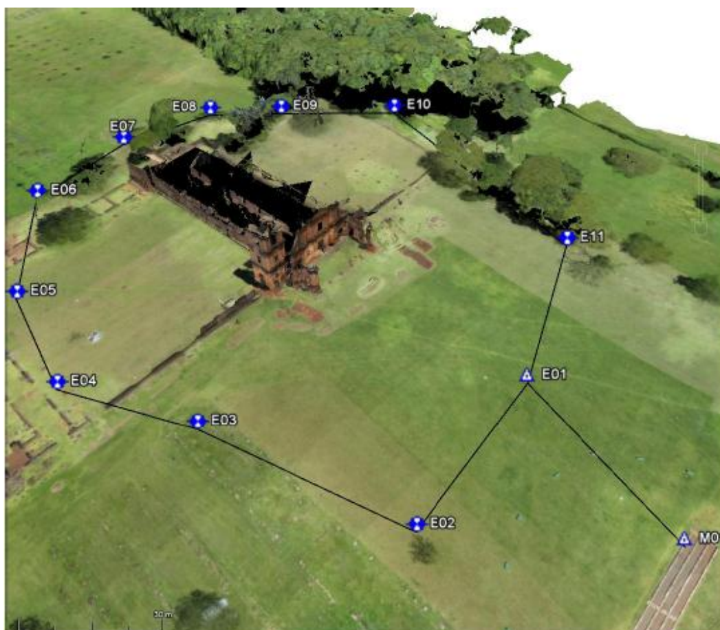
Figura 9 – Poligonal topográfica de apoio
