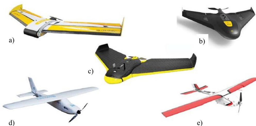
Figura 1. Exemplos de alguns Drones comerciais de asa fixa: a) QuestUAV ; b) SenseFly eBee ; c) Trimble UX5 ; d) MAVinci Sirius Pro ; e) PrecisionHawk Lancaster . Fonte: PÁDUA et al., 2017.
