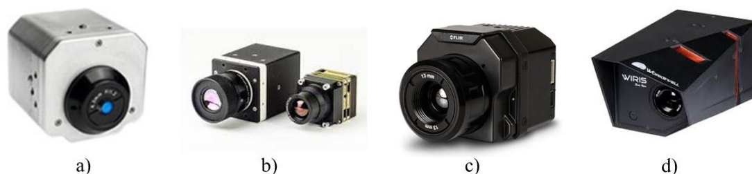
Figura 6. Algumas câmaras termais utilizadas em drones : a) Photon 320 ; b) IRMOD V640 ; c) FLIR Vue ; d) Workswell WIRIS . Fonte: PÁDUA et al. , 2017.
